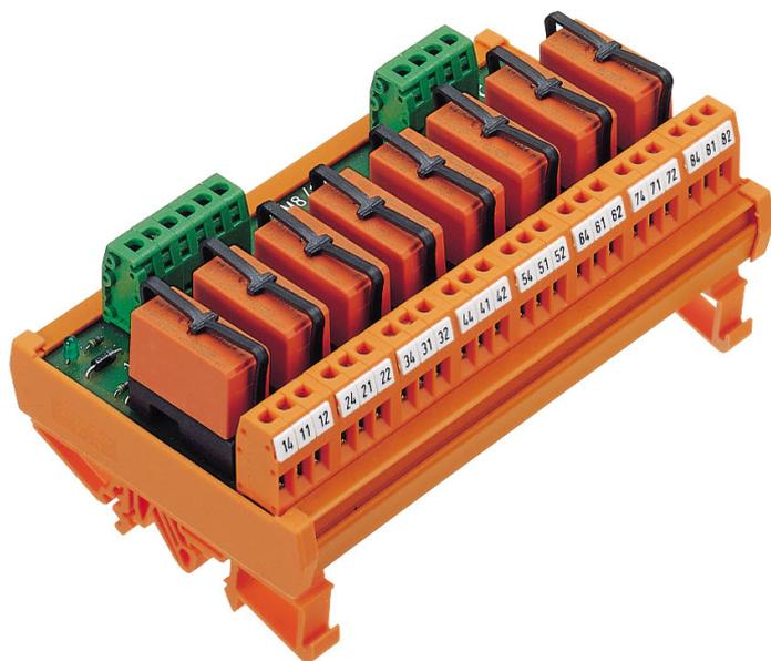
Mehrfach-Relaismodul ohne Relais, Schraubanschluss, für 8 Miniaturrelais, je 1 Wechsler, gesteckt, mit Leuchtanzeige, minusschaltend, Eingangsspannung: 24 VDC
