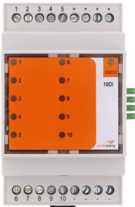
Webeasy I/O Digital-Eingangs-Modul, 10 Digital-Eingänge 24VAC/DC mit LED-Anzeige, Montageart: TS 35, Versorgungsspannungsbereich 20 V - 28 VAC/DC
