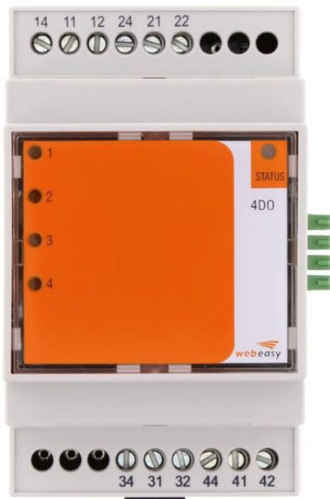
Webeasy I/O Digital-Ausgangs-Modul,4 Relais-Ausgänge 1 W, 250 V, 16 A (inrush 80A), mit LED-Anzeige, Montageart: TS 35, Versorgungsspannungsbereich 20 V - 28 VAC/DC
