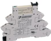
Plug-Relais-Compact (PRC) Komplett, bestehend aus Sockel PRC... mit Zugfederanschluss und steckbarem Miniaturrelais PRC... mit Leistungskontakt, Montageart: TS 35, 1 Wechsler, Eingangsspannung: 240 VAC/DC
