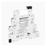
Interface-Relais-Compact (IRC) Komplett, bestehend aus Sockel FIRCU... mit Push-in-Anschluss und steckbarem Miniaturrelais mit Leistungskontakt, Montageart: TS 35, 1 Wechsler, Eingangsspannung: 240 VAC
