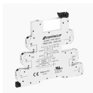
Interface-Relais-Compact (IRC) Stecksocket FIRCI I mit Push-in-Anschluss, Montageart: TS 35, 1 Wechsler, Eingangsspannung: 110 bis 125 VAC/DC
