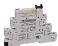
Plug-Relais-Compact (PRC) Stecksocket PRC mit Schraubanschluss und Reststromunterdrückung für lange Leitungswege, Montageart: TS 35, 1 Wechsler, Eingangsspannung: 220 bis 240 VAC
