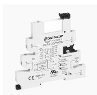
Interface-Relais-Compact (IRC) Stecksocket IRCP mit Schraubanschluss und Reststromunterdrückung für lange Leitungswege, Montageart: TS 35, 1 Wechsler, Eingangsspannung: 230 bis 240 VAC/DC
