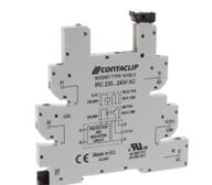
Interface-Relais-Compact (IRC) Stecksocket IRC mit Schraubanschluss, Montageart: TS 35, 1 Wechsler, Eingangsspannung: 230 bis 240 VAC
