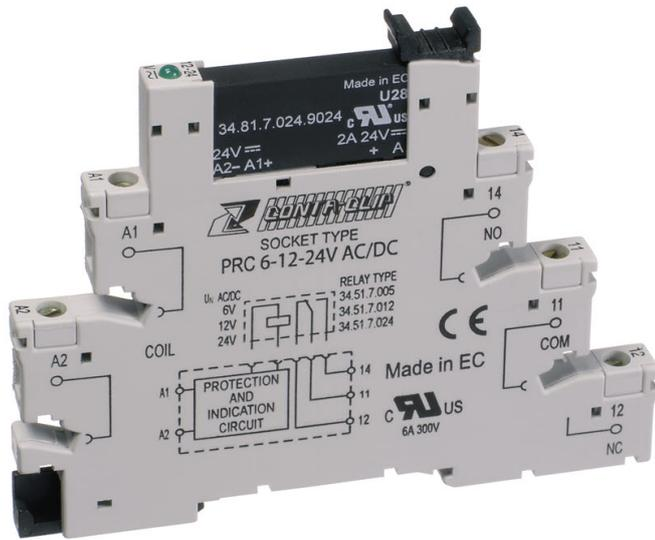
Plug-Solid-State-Compact (PSC) Komplett, bestehend aus Sockel PRC... mit Schraubanschluss und steckbarem MiniaturSSR PSC..., Montageart: TS 35, 1 Schließer, Eingangsspannung: 240 VAC
