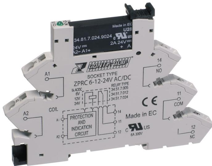
Plug-Solid-State-Compact (ZPSC) Komplett, bestehend aus Sockel ZPRC... mit Zugfederanschluss und steckbarem MiniaturSSR PSC..., Montageart: TS 35, 1 Schließer, Eingangsspannung: 24 VDC
