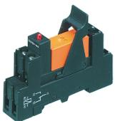
Vormontiertes Relaismodul PRS..., Schraubanschluss, bestehend aus: Relaissocket, Leistungskontaktrelais, steckbarem Anzeige-/ Entstörmodul und Haltebügel, 1 Wechsler, Eingangsspannung: 110 VDC
