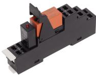
Vormontiertes Relaismodul PRS..., Zugfederanschluss, bestehend aus: Relaissocket, Leistungskontaktrelais, steckbarem Anzeige-/ Entstörmodul und Haltebügel, 1 Wechsler, Eingangsspannung: 110 VDC
