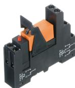
Vormontiertes Relaismodul PRS..., Schraubanschluss, bestehend aus: Relaissocket, Leistungskontaktrelais, steckbarem Anzeige-/Entstörmodul und Haltebügel, 2 Wechsler, Eingangsspannung: 110 VDC
