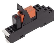
Vormontiertes Relaismodul PRS..., Zugfederanschluss, bestehend aus: Relaissocket, Leistungskontaktrelais, steckbarem Anzeige-/Entstörmodul und Haltebügel, 2 Wechsler, Eingangsspannung: 110 VDC
