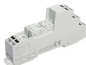
Relais-Stecksocket PRS, für Miniatur-Leistungserelais mit 2-Wechslern, Push-in Anschluss, Steckmöglichkeit für Eingangs-/Entstörmodule und Querverbinder, Montageart: TS 35, Bemessungsquerschnitt: 1,5mm<sup>2</sup>, Bemessungsspannung 300V
