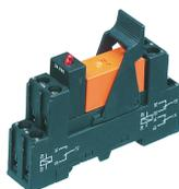
Vormontiertes Relaismodul PRS..., Schraubanschluss, bestehend aus: Relaissocket, Leistungskontaktrelais, steckbarem Anzeige-/Entstörmodul und Haltebügel, 2 Wechsler, Eingangsspannung: 110 VDC
