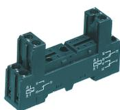
Relais-Stecksocket PRS, für Miniatur-Leistungserelais mit 2-Wechsler, Schraubanschluss, Steckmöglichkeit für Eingangs-/Entstörmodule, Montageart: TS 35
