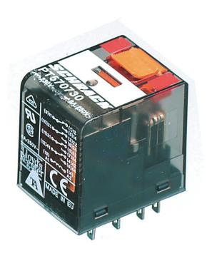
Steckbare Industrierelais mit Leistungskontakten, 4 Wechsler, Prüftaste, mechanische Schaltstellungsanzeige, Polarität A1+, A2-, Eingangsspannung: 110 VDC
