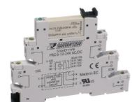
Plug-Relais-Compact (PRC) Komplett, bestehend aus Sockel PRC... mit Schraubanschluss und steckbarem Miniaturrelais PRC... mit Leistungskontakt, Montageart: TS 35, 1 Wechsler, Eingangsspannung: 125 VAC/DC
