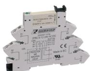
Plug-Relais-Compact (PRC) Stecksocket PRC mit Zugfederanschluss und Reststromunterdrückung für lange Leitungswege, Montageart: TS 35, 1 Wechsler, Eingangsspannung: 110 bis 125 VAC/DC
