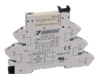
Plug-Relais-Compact (PRC) Komplett, bestehend aus Sockel PRC... mit Zugfederanschluss und steckbarem Miniaturrelais PRC... mit Leistungskontakt, Montageart: TS 35, 1 Wechsler, Eingangsspannung: 125 VAC/DC
