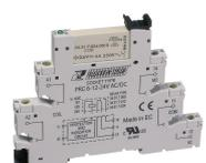
Plug-Relais-Compact (PRC) Stecksocket PRC mit Schraubanschluss, Montageart: TS 35, 1 Wechsler, Eingangsspannung: 6,12 oder 24 VAC/DC
