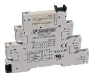
Plug-Relais-Compact (PRC) Komplett, bestehend aus Sockel PRC... mit Schraubanschluss und steckbarem Miniaturrelais PRC... mit Leistungskontakt, Montageart: TS 35, 1 Wechsler, Eingangsspannung: 125 VAC/DC
