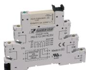
Plug-Relais-Compact (PRC) Stecksocket PRC mit Schraubanschluss und Reststromunterdrückung für lange Leitungswege, Montageart: TS 35, 1 Wechsler, Eingangsspannung: 220 bis 240 VAC
