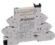
Plug-Relais-Compact (PRC) Stecksocket PRC mit Zugfederanschluss, Montageart: TS 35, 1 Wechsler, Eingangsspannung: 6,12 oder 24 VAC/DC
