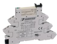
Plug-Relais-Compact (PRC) Komplett, bestehend aus Sockel PRC... mit Schraubanschluss und steckbarem Miniaturrelais PRC... mit Leistungskontakt, Montageart: TS 35, 1 Wechsler, Eingangsspannung: 24 VDC
