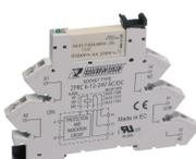
Plug-Relais-Compact (PRC) Komplett, bestehend aus Sockel PRC... mit Zugfederanschluss und steckbarem Miniaturrelais PRC... mit Leistungskontakt, Montageart: TS 35, 1 Wechsler, Eingangsspannung: 12 VAC/DC
