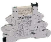
Plug-Relais-Compact (PRC) Stecksocket PRC mit Zugfederanschluss und Reststromunterdrückung für lange Leitungswege, Montageart: TS 35, 1 Wechsler, Eingangsspannung: 220 bis 240 VAC
