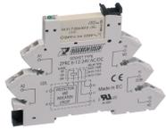
Plug-Relais-Compact (PRC) Stecksocket PRC mit Zugfederanschluss, Montageart: TS 35, 1 Wechsler, Eingangsspannung: 220 bis 240 VAC/DC
