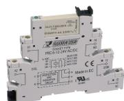
Plug-Relais-Compact (PRC) Komplett, bestehend aus Sockel PRC... mit Schraubanschluss und steckbarem Miniaturrelais PRC... mit Leistungskontakt, Montageart: TS 35, 1 Wechsler, Eingangsspannung: 240 VAC/DC
