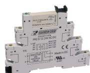
Plug-Relais-Compact (PRC) Komplett, bestehend aus Sockel PRC... mit Schraubanschluss und steckbarem Miniaturrelais PRC... mit Leistungskontakt, Montageart: TS 35, 1 Wechsler, Eingangsspannung: 12 VDC
