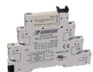
Plug-Relais-Compact (PRC) Komplett, bestehend aus Sockel PRC... mit Schraubanschluss und steckbarem Miniaturrelais PRC... mit Leistungskontakt, Montageart: TS 35, 1 Wechsler, Eingangsspannung: 24 VAC/DC
