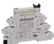
Plug-Relais-Compact (PRC) Komplett, bestehend aus Sockel PRC... mit Schraubanschluss und steckbarem Miniaturrelais PRC... mit Leistungskontakt, Montageart: TS 35, 1 Wechsler, Eingangsspannung: 24 VAC/DC
