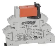
Plug-Relais-Compact (PRC) Komplett, bestehend aus Sockel PRC... mit Zugfederanschluss und steckbarem Miniaturrelais PRS... mit Inrush-Leistungskontakt, Montageart: TS 35, 1 Wechsler, Eingangsspannung: 24 VAC/DC
