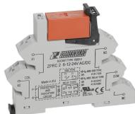
Plug-Relais-Compact (PRC) Komplett, bestehend aus Sockel PRC... mit Zugfederanschluss und steckbarem Miniaturrelais PRS... mit Leistungskontakt, Montageart: TS 35, 2 Wechsler, Eingangsspannung: 12 VAC/DC
