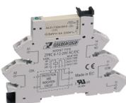
Plug-Relais-Compact (PRC) Komplett, bestehend aus Sockel PRC... mit Schraubanschluss und steckbarem Miniaturrelais PRC... mit Leistungskontakt, Montageart: TS 35, 1 Wechsler, Eingangsspannung: 24 VDC
