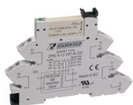
Plug-Relais-Compact (PRC) Komplet, bestehend aus Sockel PRC... mit Schraubanschluss und steckbarem Miniaturrelais PRC... mit Leistungskontakt, Montageart: TS 35, 1 Wechsler, Eingangsspannung: 48 VAC/DC
