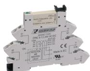
Plug-Relais-Compact (PRC) Komplet, bestehend aus Sockel PRC... mit Zugfederanschluss und steckbarem Miniaturrelais PRC... mit Leistungskontakt, Montageart: TS 35, 1 Wechsler, Eingangsspannung: 240 VAC/DC
