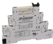
Plug-Relais-Compact (PRC) Stecksockel PRC mit Schraubanschluss und Reststromunterdrückung für lange Leitungswege, Montageart: TS 35, 1 Wechsler, Eingangsspannung: 110 bis 125 VAC/DC
