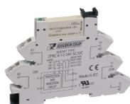
Plug-Relais-Compact (PRC) Komplett, bestehend aus Sockel PRC... mit Schraubanschluss und steckbarem Miniaturrelais PRC... mit Leistungskontakt, Montageart: TS 35, 1 Wechsler, Eingangsspannung: 48 VAC/DC
