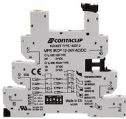
Multifunktions-Zeitrelais, Interface-Relais-Compact (IRC) Stecksocket MFR-IRCP mit Schraubanschluss, Montageart: TS 35, 1 Wechsler, Eingangsspannung: 12 bis 24VAC/DC
