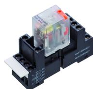
Vormontiertes Relaismodul PRS..., Schraubanschluss, bestehend aus: Relaissocket und Leistungskontaktrelais, 4 Wechsler, Eingangsspannung: 24 VAC
