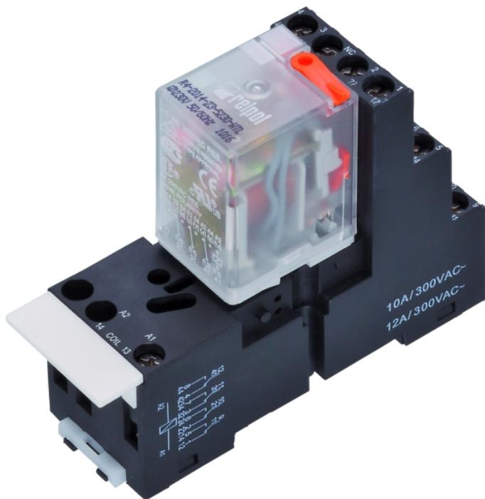
Vormontiertes Relaismodul PRS..., Schraubanschluss, bestehend aus: Relaissockel und Leistungskontaktrelais, 4 Wechsler, Eingangsspannung: 230 VAC
