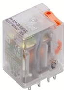
Steckbare Industrirelais mit Leistungskontakten, 2 Wechsler, Prüftaste, Status-LED, mechanische Schaltstellungsanzeige, Eingangsspannung: 230 VAC
