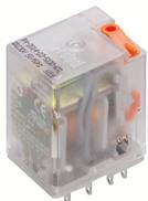
Steckbare Industrirelais mit Leistungskontakten, 2 Wechsler, Prüftaste, Status-LED, Freilaufdiode, mechanische Schaltstellungsanzeige, Polarität A1+, A2-, Eingangsspannung: 24 VDC
