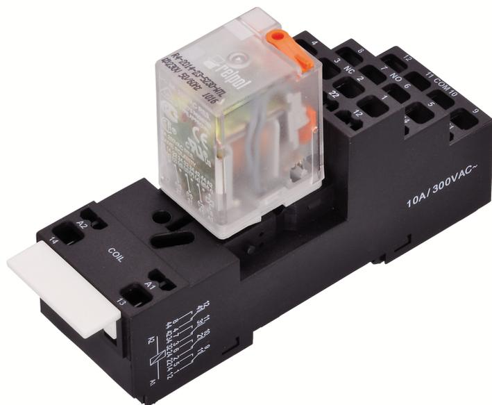
Vormontiertes Relaismodul PRSU..., Zugfederanschluss, bestehend aus: Relaissockel und Leistungskontaktrelais, 4 Wechsler, Eingangsspannung: 24 VDC
