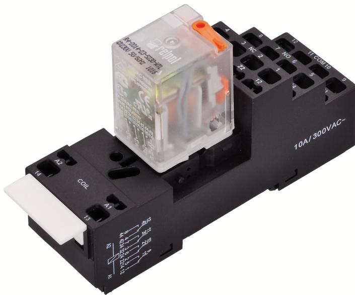
Vormontiertes Relaismodul PRSU..., Zugfederanschluss, bestehend aus: Relaissockel und Leistungskontaktrelais, 4 Wechsler, Eingangsspannung: 24 VAC
