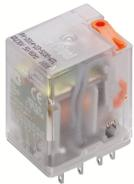
Steckbare Industrirelais mit Leistungskontakten, 2 Wechsler, Prüftaste, Status-LED, mechanische Schaltstellungsanzeige, Eingangsspannung: 24 VAC
