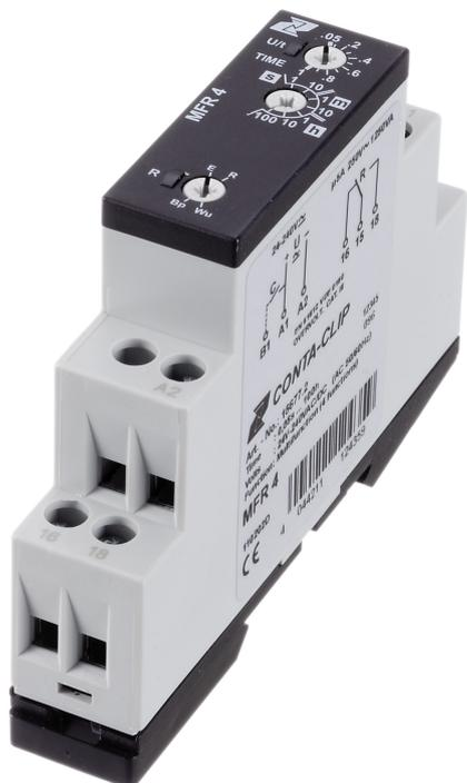
Multifunktions-Zeitrelais-Baustein mit 4 Funktionen und einem einstellbaren Zeitbereich (50 ms - 100 h), Schraubanschluss, Montageart: TS 35, 1 Wechsler
