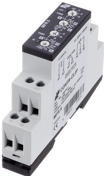
Taktgeber-Zweizeitrelais-Baustein mit 2 Funktionen und 2 einstellbaren Zeitbereichen (50 ms - 100 h), Schraubanschluss, Montageart: TS 35, 1 Wechsler
