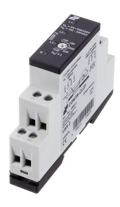
Unterspannung-Überwachungsrelais-Baustein mit einstellbarer Schaltschwelle (160 - 240 V), Schraubanschluss, Montageart: TS 35, 1 Wechsler
