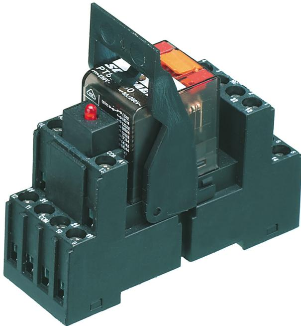
Vormontiertes Relaismodul PRS..., Schraubanschluss, bestehend aus: Relaissockel, Leistungskontaktrelais, steckbarem Anzeige-/ Entstörmodul und Haltebügel, 4 Wechsler, Eingangsspannung: 48 VDC
