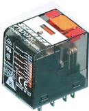
Steckbare Industrirelais mit Leistungskontakten, 4 Wechsler, Prüftaste, mechanische Schaltstellungsanzeige, Polarität A1+, A2-, Eingangsspannung: 48 VDC
