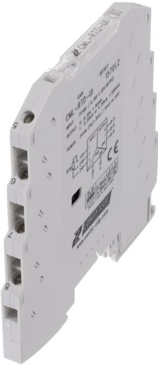
Signalwandler für den Anschluss von PT 100 Thermosensoren auf ein analoges Normsignal, Schraubanschluss, Montageart: TS 35, Versorgungsspannung: 24 VDC
