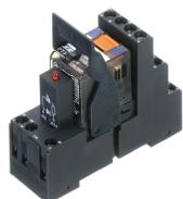
Vormontiertes Relaismodul PRS..., Schraubanschluss, bestehend aus: Relaissockel, Leistungskontaktrelais, steckbarem Anzeige-/ Entstörm modul und Haltebügel, 4 Wechsler, Eingangsspannung: 24 VAC
