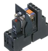
Vormontiertes Relaismodul PRS..., Schraubanschluss, bestehend aus: Relaissockel, Leistungskontaktrelais, steckbarem Anzeige-/ Entstörm modul und Haltebügel, 4 Wechsler, Eingangsspannung: 48 VDC
