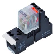
Vormontiertes Relaismodul PRS..., Schraubanschluss, bestehend aus: Relaissockel und Leistungskontaktrelais, 4 Wechsler, Eingangsspannung: 24 VDC
