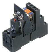
Vormontiertes Relaismodul PRS..., Schraubanschluss, bestehend aus: Relaissockel, Leistungskontaktrelais, steckbarem Anzeige-/ Entstörm modul und Haltebügel, 4 Wechsler, Eingangsspannung: 115 VAC
