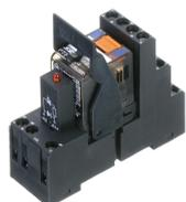
Vormontiertes Relaismodul PRS..., Schraubanschluss, bestehend aus: Relaissockel, Leistungskontaktrelais, steckbarem Anzeige-/ Entstörm modul und Haltebügel, 4 Wechsler, Eingangsspannung: 12 VDC
