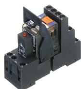
Vormontiertes Relaismodul PRS..., Schraubanschluss, bestehend aus: Relaissockel, Leistungskontaktrelais, steckbarem Anzeige-/ Entstörmodul und Haltebügel, 4 Wechsler, Eingangsspannung: 230 VAC
