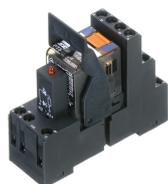
Vormontiertes Relaismodul PRS..., Schraubanschluss, bestehend aus: Relaissockel, Leistungskontaktrelais, steckbarem Anzeige-/ Entstörm modul und Haltebügel, 4 Wechsler, Eingangsspannung: 230 VAC
