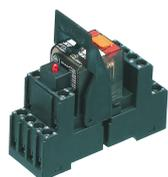
Vormontiertes Relaismodul PRS..., Schraubanschluss, bestehend aus: Relaissockel, Leistungskontaktrelais, steckbarem Anzeige-/ Entstörm modul und Haltebügel, 4 Wechsler, Eingangsspannung: 115 VAC
