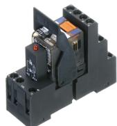
Vormontiertes Relaismodul PRS..., Schraubanschluss, bestehend aus: Relaissockel, Leistungskontaktrelais, steckbarem Anzeige-/ Entstörmodul und Haltebügel, 4 Wechsler, Eingangsspannung: 110 VDC
