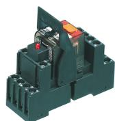
Vormontiertes Relaismodul PRS..., Schraubanschluss, bestehend aus: Relaissockel, Leistungskontaktrelais, steckbarem Anzeige-/ Entstörm modul und Haltebügel, 4 Wechsler, Eingangsspannung: 220 VDC
