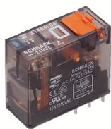
Steckbare Industrirelais mit Leistungskontakten, 1 Wechsler, Prüftaste, Status-LED, Freilaufdiode, mechanische Schaltstellungsanzeige, Polarität A1+, A2-, Eingangsspannung: 24 VDC
