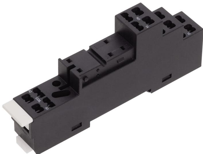
Relais-Stecksocket PRS, für Miniatur-Leistungserelais mit 1-Wechsler, Zugfederanschluss, Steckmöglichkeit für Eingangs-/Entstörmodule, Montageart: TS 35
