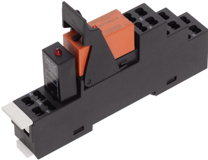
Vormontiertes Relaismodul PRS..., Zugfederanschluss, bestehend aus: Relaissockel, Leistungskontaktrelais, steckbarem Anzeige-/ Entstörmodul und Haltebügel, 1 Wechsler, Eingangsspannung: 60 VDC
