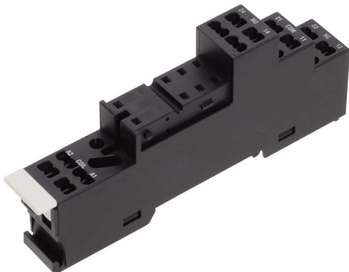
Relais-Stecksocket PRS, für Miniatur-Leistungserelais mit 2-Wechslern, Zugfederanschluss, Steckmöglichkeit für Eingangs-/Entstörmodule, Montageart: TS 35
