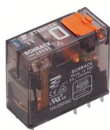
Steckbare Industrieries mit Leistungskontakten, 1 Wechsler, Prüftaste, Status-LED, Freilaufdiode, mechanische Schaltstellungsanzeige, Polarität A1+, A2-, Eingangsspannung: 24 VDC
