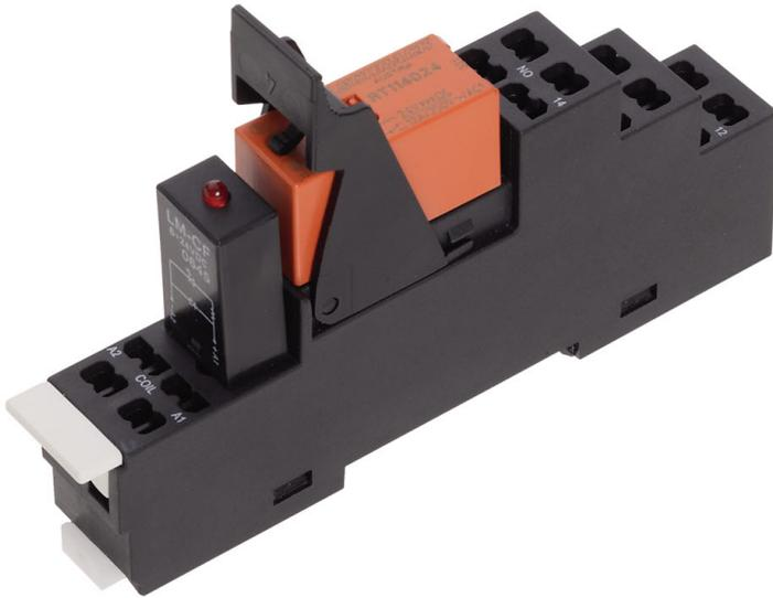
Vormontiertes Relaismodul PRS..., Zugfederanschluss, bestehend aus: Relaissockel, Leistungskontaktrelais, steckbarem Anzeige-/ Entstörmodul und Haltebügel, 2 Wechsler, Eingangsspannung: 24 VDC
