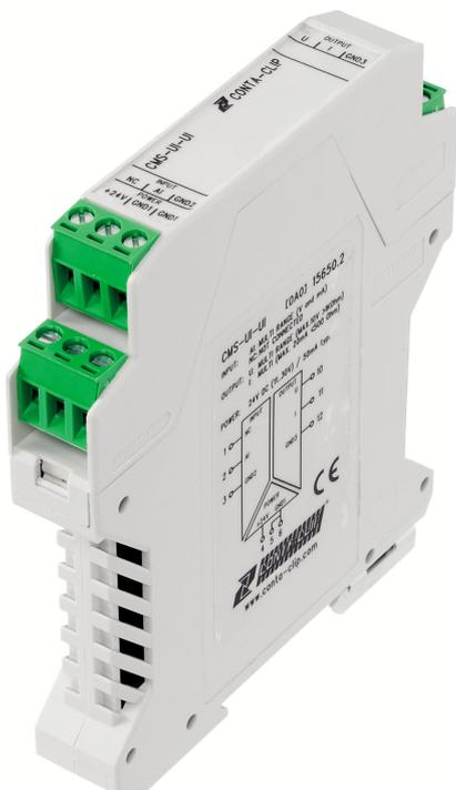
Signalwandler zur Umwandlung von Spannungs/Stromsignalen auf einen Relaisausgang, 3-Wege galvanische Trennung, Schraubanschluss, Montageart: TS 35, Versorgungsspannung: 24 VDC
