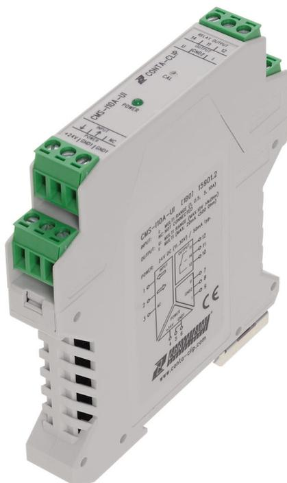
Signalwandler zur Umwandlung von Stromsignalen bis 10A auf ein analoges Normsignal, 3-Wege galvanische Trennung, Schraubanschluss, Montageart: TS 35, Versorgungsspannung: 24 VDC
