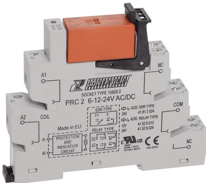
Plug-Relais-Compact (PRC) Komplett, bestehend aus Sockel PRC... mit Schraubanschluss und steckbarem Miniaturrelais PRS... mit Leistungskontakt, Montageart: TS 35, 2 Wechsler, Eingangsspannung: 24 VAC/DC
