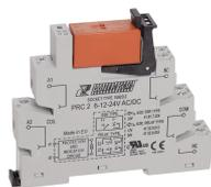
Plug-Relais-Compact (PRC) Komplett, bestehend aus Sockel PRC... mit Schraubanschluss und steckbarem Miniaturrelais PRS... mit Inrush-Leistungskontakt, Montageart: TS 35, 1 Wechsler, Eingangsspannung: 24 VAC/DC
