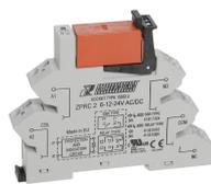
Plug-Relais-Compact (PRC) Komplett, bestehend aus Sockel PRC... mit Zugfederanschluss und steckbarem Miniaturrelais PRS... mit Leistungskontakt, Montageart: TS 35, 2 Wechsler, Eingangsspannung: 240 VAC/DC
