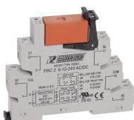
Plug-Relais-Compact (PRC) Komplett, bestehend aus Sockel PRC... mit Schraubanschluss und steckbarem Miniaturrelais PRS... mit Leistungskontakt, Montageart: TS 35, 2 Wechsler, Eingangsspannung: 12 VAC/DC
