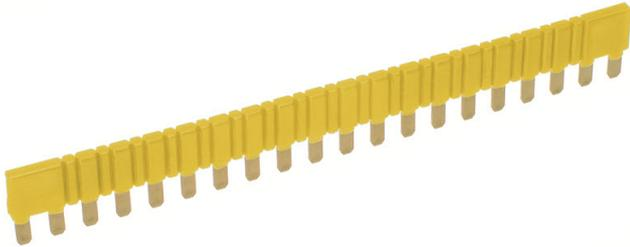
Außenquerverbinder isoliert für Plug-Relais-Compact (PRC 2), 8-polig, kürzbar, Spannung: 250V, Strom 10 A
