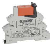
Plug-Relais-Compact (PRC) Komplett, bestehend aus Sockel PRC... mit Zugfederanschluss und steckbarem Miniaturrelais PRS... mit Inrush-Leistungskontakt, Montageart: TS 35, 1 Wechsler, Eingangsspannung: 24 VAC/DC
