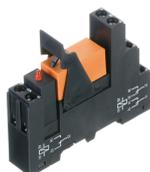
Vormontiertes Relaismodul PRS..., Schraubanschluss, bestehend aus: Relaissockel, Leistungskontaktrelais, steckbarem Anzeige-/ Entstörmodul und Haltebügel, 2 Wechsler, Eingangsspannung: 48 VAC
