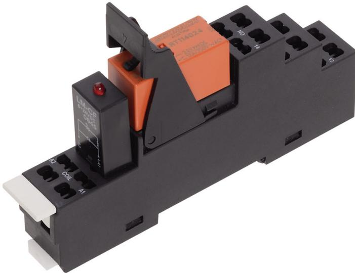
Vormontiertes Relaismodul PRS..., Zugfederanschluss, bestehend aus: Relaissockel, Leistungskontaktrelais, steckbarem Anzeige-/ Entstörmodul und Haltebügel, 2 Wechsler, Eingangsspannung: 48 VAC
