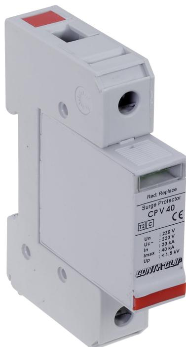
Überspannungsableiter Typ 2 bestehend aus Basiselement und Schutzstecker mit Hochleistungsvaristor, Montageart: TS 35, 1-Kanal, Nennspannung: 230 VAC
