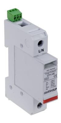
Überspannungsableiter Typ 2 bestehend aus Basiselement und Schutzstecker mit Hochleistungsvaristor, Fernmeldekontakt, Montageart: TS 35, 1-Kanal, Nennspannung: 230 VAC
