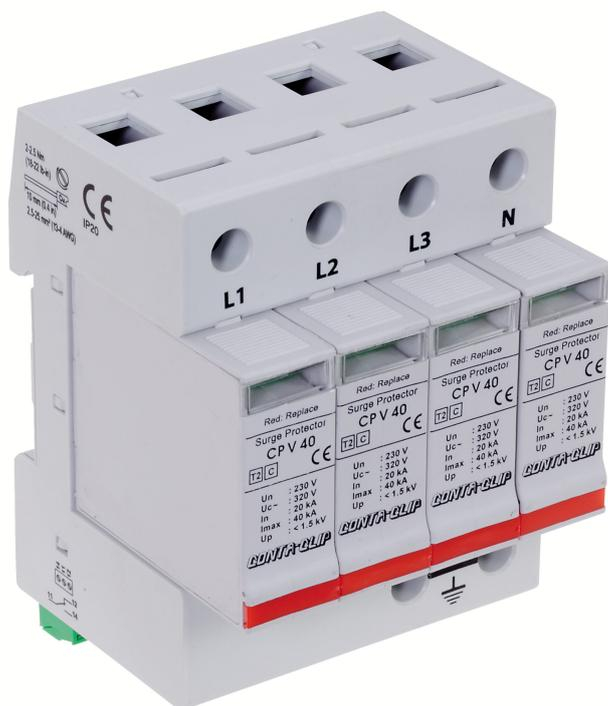
Überspannungsableiter Typ 2 bestehend aus Basiselement und Schutzstecker mit Hochleistungsvaristor, Fernmeldekontakt, Montageart: TS 35, 4 Kanäle, Nennspannung: 230 VAC
