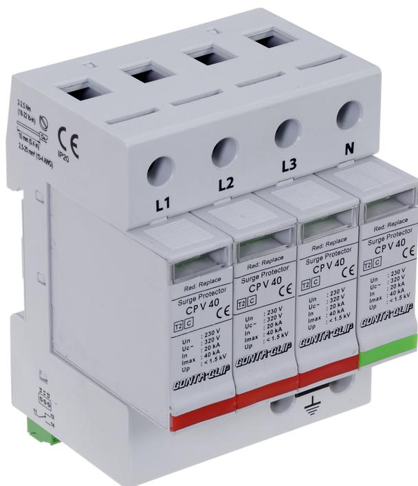
Überspannungsableiter Typ 2 bestehend aus Basiselement und Schutzstecker mit Hochleistungsvaristor und Gasableiter, Fernmeldekontakt, Montageart: TS 35, 4 Kanäle, Nennspannung: 230 VAC
