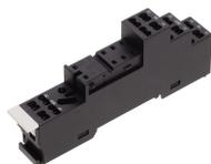
Relais-Stecksocket PRS, für Miniatur-Leistungserlais mit 2-Wechslern, Zugfederanschluss, Steckmöglichkeit für Eingangs-/Entstörmodule, Montageart: TS 35
