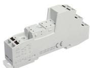
Relais-Stecksocket PRS, für Miniatur-Leistungserlais mit 2-Wechslern, Push-in Anschluss, Steckmöglichkeit für Eingangs-/Entstörmodule und Querverbinder, Montageart: TS 35, Bemessungsquerschnitt: 1,5mm<sup>2</sup>, Bemessungsspannung 300V
