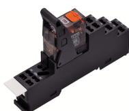
Vormontiertes Relaismodul PRSXT, Zugfederanschluss, bestehend aus: Relaissockel, Haltebügel und Leistungskontaktrelais mit Prüftaste und Status-LED. 1 Wechsler, Eingangsspannung: 24 VDC
