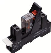
Vormontiertes Relaismodul PRSXT, Schraubanschluss, bestehend aus: Relaissockel, Haltebügel und Leistungskontaktrelais mit Prüftaste und Status-LED. 2 Wechsler, Eingangsspannung: 24 VAC
