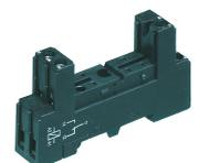
Relais-Stecksocket PRS, für Miniatur-Leistungserelais mit 1-Wechsler, Schraubanschluss, Steckmöglichkeit für Eingangs-/Entstörmodule, Montageart: TS 35
