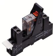
Vormontiertes Relaismodul PRSXT, Schraubanschluss, bestehend aus: Relaissockel, Haltebügel und Leistungskontaktrelais mit Prüftaste und Status-LED. 2 Wechsler, Eingangsspannung: 230 VAC
