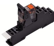
Vormontiertes Relaismodul PRSXT, Zugfederanschluss, bestehend aus: Relaissockel, Haltebügel und Leistungskontaktrelais mit Prüftaste und Status-LED. 1 Wechsler, Eingangsspannung: 230 VAC
