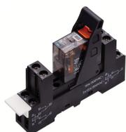
Vormontiertes Relaismodul PRSXT, Schraubanschluss, bestehend aus: Relaissockel, Haltebügel und Leistungskontaktrelais mit Prüftaste und Status-LED. 1 Wechsler, Eingangsspannung: 24 VDC
