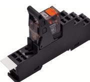
Vormontiertes Relaismodul PRSXT, Zugfederanschluss, bestehend aus: Relaissockel, Haltebügel und Leistungskontaktrelais mit Prüftaste und Status-LED. 1 Wechsler, Eingangsspannung: 230 VAC
