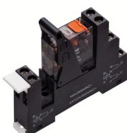
Vormontiertes Relaismodul PRSXT, Schraubanschluss, bestehend aus: Relaissockel, Haltebügel und Leistungskontaktrelais mit Prüftaste und Status-LED. 1 Wechsler, Eingangsspannung: 230 VAC
