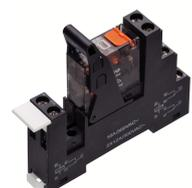
Vormontiertes Relaismodul PRSXT, Schraubanschluss, bestehend aus: Relaissockel, Haltebügel und Leistungskontaktrelais mit Prüftaste und Status-LED. 1 Wechsler, Eingangsspannung: 230 VAC
