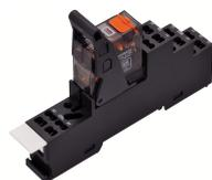
Vormontiertes Relaismodul PRSXT, Zugfederanschluss, bestehend aus: Relaissockel, Haltebügel und Leistungskontaktrelais mit Prüftaste und Status-LED. 1 Wechsler, Eingangsspannung: 24 VAC
