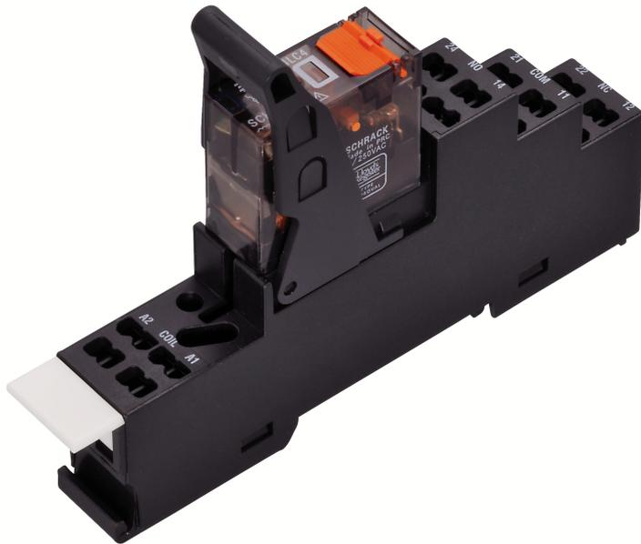
Vormontiertes Relaismodul PRSXT, Zugfederanschluss, bestehend aus: Relaissockel, Haltebügel und Leistungskontaktrelais mit Prüftaste und Status-LED. 2 Wechsler, Eingangsspannung: 24 VDC
