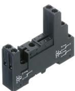
Relais-Stecksocket PRS, für Miniatur-Leistungserlais mit 2-Wechslern, Schraubanschluss, Steckmöglichkeit für Eingangs-/Entstörmodule, Montageart: TS 35
