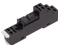
Relais-Stecksocket PRS, für Miniatur-Leistungserlais mit 1-Wechsler, Zugfederanschluss, Steckmöglichkeit für Eingangs-/Entstörmodule, Montageart: TS 35
