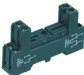
Relais-Stecksocket PRS, für Miniatur-Leistungserlais mit 2-Wechslern, Schraubanschluss, Steckmöglichkeit für Eingangs-/Entstörmodule, Montageart: TS 35
