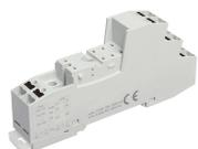
Relais-Stecksockel PRS, für Miniatur-Leistungserlais mit 2-Wechslern, Push-in Anschluss, Steckmöglichkeit für Eingangs-/Entstörmodule und Querverbinder, Montageart: TS 35, Bemessungsquerschnitt: 1,5mm<sup>2</sup>, Bemessungsspannung 300V
