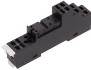
Relais-Stecksocket PRS, für Miniatur-Leistungserelais mit 1-Wechsler, Zugfederanschluss, Steckmöglichkeit für Eingangs-/Entstörmodule, Montageart: TS 35
