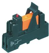
Vormontiertes Relaismodul PRS..., Schraubanschluss, bestehend aus: Relaissocket, Leistungskontaktrelais, steckbarem Anzeige-/Entstörmodul und Haltebügel, 1 Wechsler, Eingangsspannung: 5 VDC
