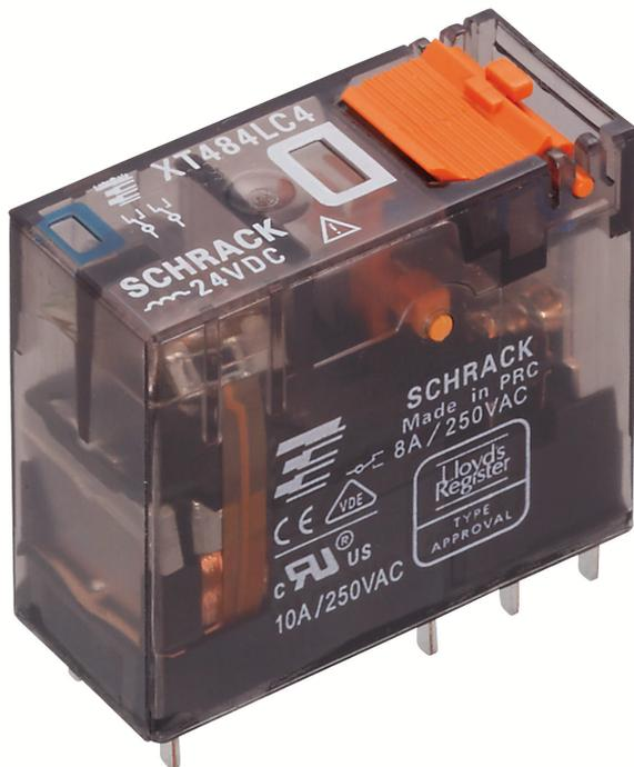
Steckbare Industrirelais mit Leistungskontakten, 1 Wechsler, Prüftaste, Status-LED, Freilaufdiode, mechanische Schaltstellungsanzeige, Polarität A1+, A2-, Eingangsspannung: 24 VDC
