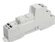
Relais-Stecksocket PRS, für Miniatur-Leistungserelais mit 2-Wechsler, Push-in Anschluss, Steckmöglichkeit für Eingangs-/Entstörmodule und Querverbinder, Montageart: TS 35, Bemessungsquerschnitt: 1,5mm<sup>2</sup>, Bemessungsspannung 300V
