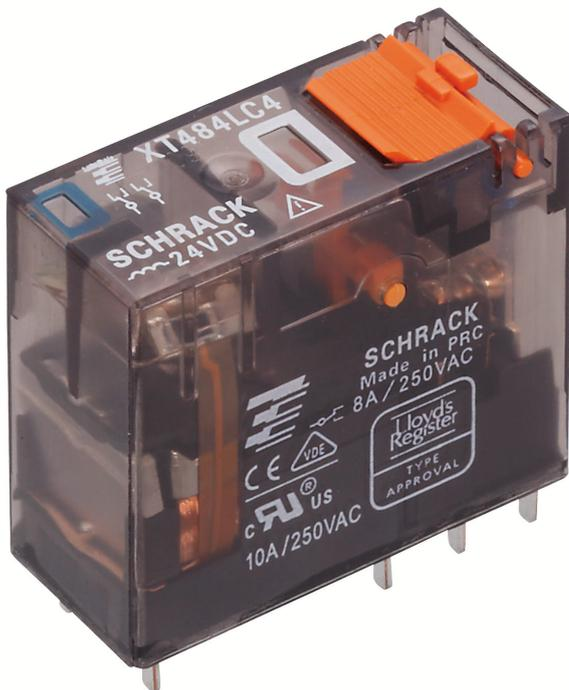
Steckbare Industrirelais mit Leistungskontakten, 1 Wechsler, Prüftaste, Status-LED, mechanische Schaltstellungsanzeige, Eingangsspannung: 24 VAC
