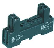
Relais-Stecksocket PRS, für Miniatur-Leistungserelais mit 2-Wechslern, Schraubanschluss, Steckmöglichkeit für Eingangs-/Entstörmodule, Montageart: TS 35
