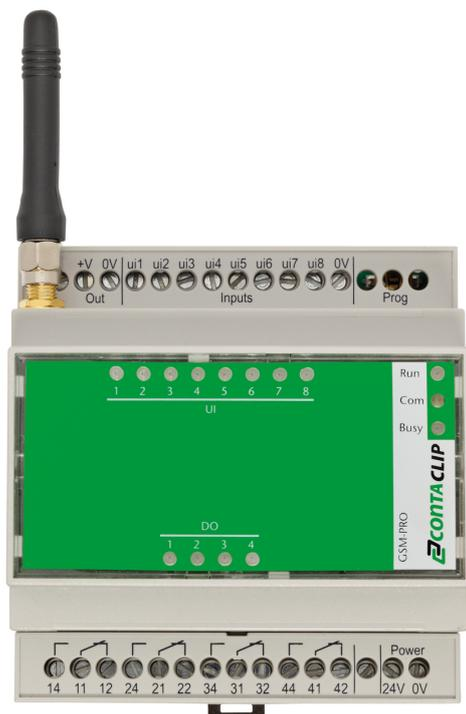
Kompaktes Meldesystem für Mobilfunknetze, um analoge und digitale Werte zu überwachen sowie Relaisausgänge aus der Ferne zu schalten. Montageart: TS 35, Versorgungsspannungsbereich 10 V - 30 V DC
