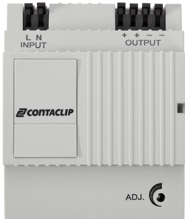
Primär getaktete Stromversorgung, Zugfeder-Anschluss, Montageart: TS 35, Eingang: 1-phasig, Ausgang: 24 VDC/2,5 A
