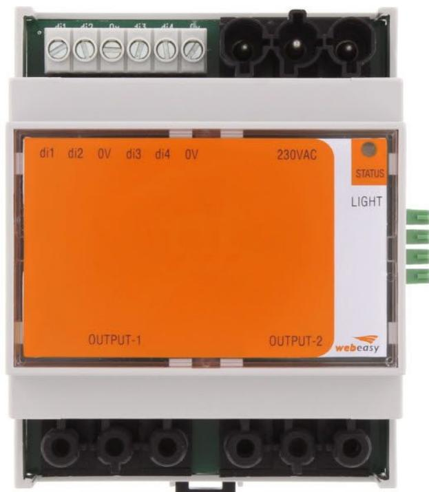
Webeasy I/O Lichtsteuerungs Modul, 4 Digital-Eingänge, 2 Relais-Ausgänge, beim Ausfall der Busverbindung schalten die Ausgänge auf Voreinstellung, Montageart: TS 35, Versorgungsspannungsbereich 20 V - 28 VAC/DC
