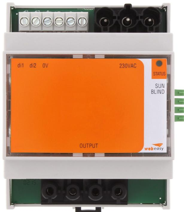
Weeasy I/O Jalousiesteuerungs Modul, 4 Digital-Eingänge, 2 Relais-Ausgänge, beim Ausfall der Busverbindung schalten die Ausgänge auf Voreinstellung, Montageart: TS 35, Versorgungsspannungsbereich 20 V - 28 VAC/DC
