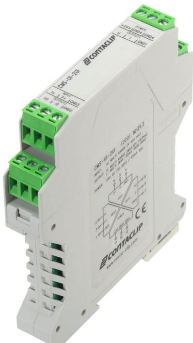
Signalwandler zur Umwandlung von Spannungs/Stromsignalen auf zwei analoge Normsignale, Schraubanschluss, Montageart: TS 35, Versorgungsspannung: 24 VDC
